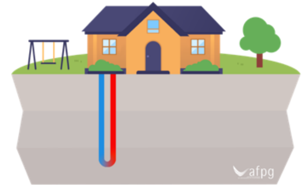
Echangeurs « fermés » Géothermie sur sondes
