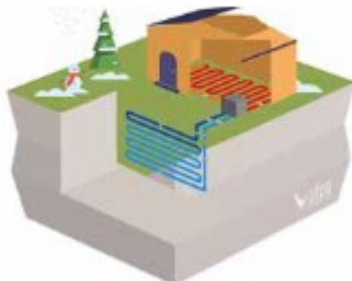
Schéma n°5: Mur géothermique
